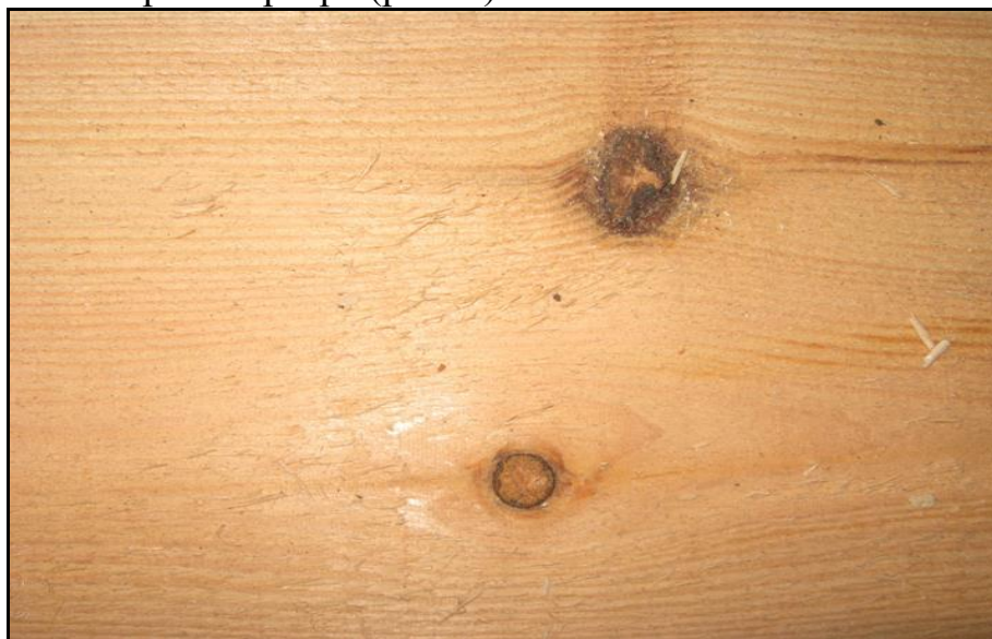
Рис. 1. Фотография участка пиломатериала с двумя дефектами.
