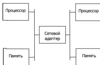
Рис.1 Конфигурация дублированного вычислительного комплекса с организацией межмашинного обмена
